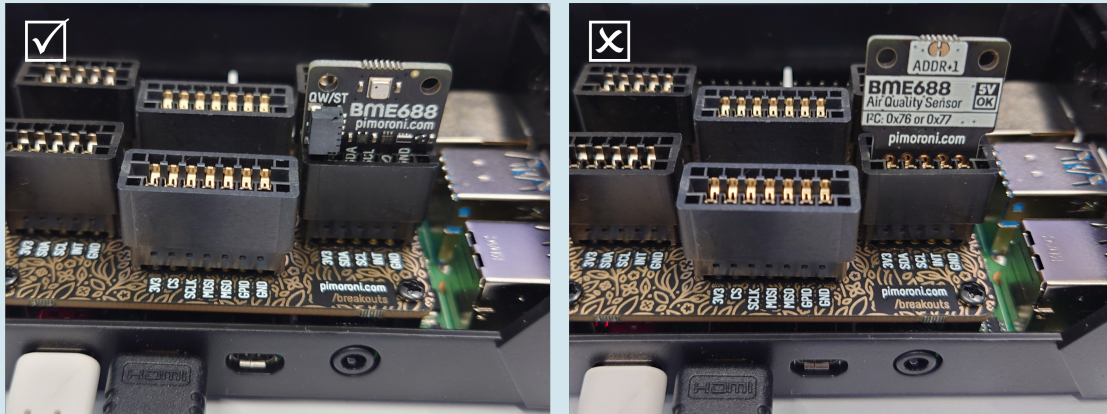
Abb. 3: Sensor links korrekt angeschlossen, rechts falsch ausgerichtet angeschlossen.
