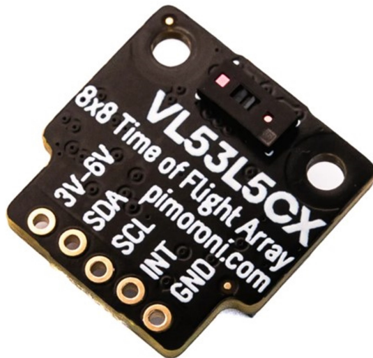
Abb. 7.2.: links: VL53L5CX Breakout von Pimoroni, rechts: schematische Darstellung TOF Moduls Quelle: STMicroelectronics (2023)
